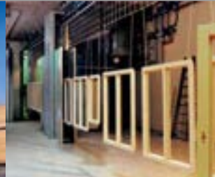
Inbetriebnahme der vollautomatischen Lackieranlage für Holzfenster
