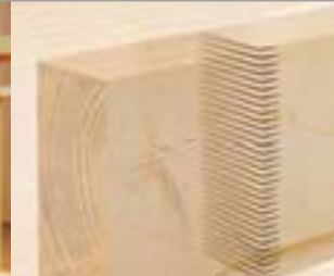
Inbetriebnahme der Keilzinkanlage für Konstruktionsvollholz
